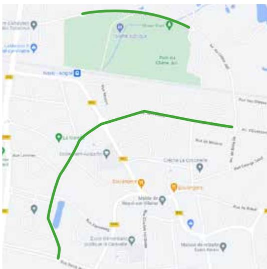
Très courant dans les pays du nord de l'Europe, ce type de liaison douce est une alternative efficace lorsque la chaussée n'est pas assez large pour envisager l'aménagement d'une piste cyclable classique. Le chaucidou permet de partager la chaussée entre les vélos et les véhicules motorisés de façon sécurisée pour les cyclistes.
