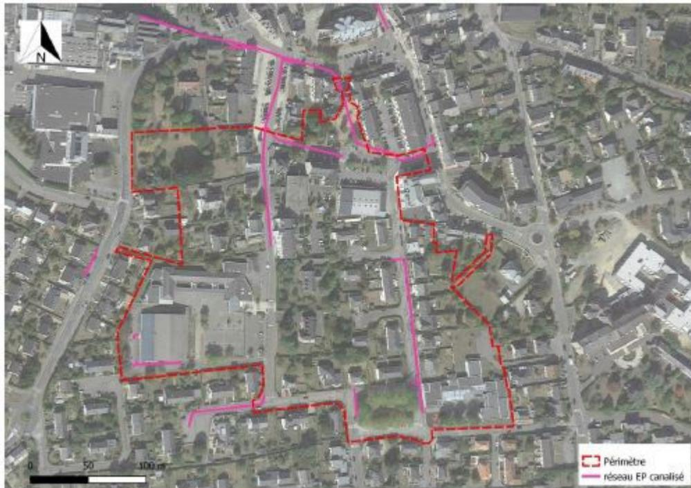
*réseau d'eau pluviale sur le centre-ville (source : setur)*
