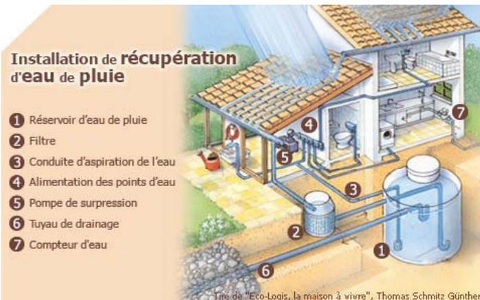
*Récupération des eaux pluviales en "second circuit" pour des usages domestiques*
